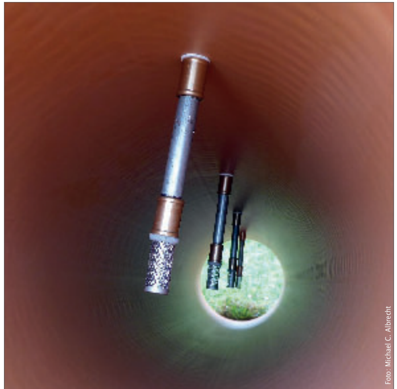
Die Sonden in der Säule messen Gasgehalte in verschiedenen Bodentiefen.
