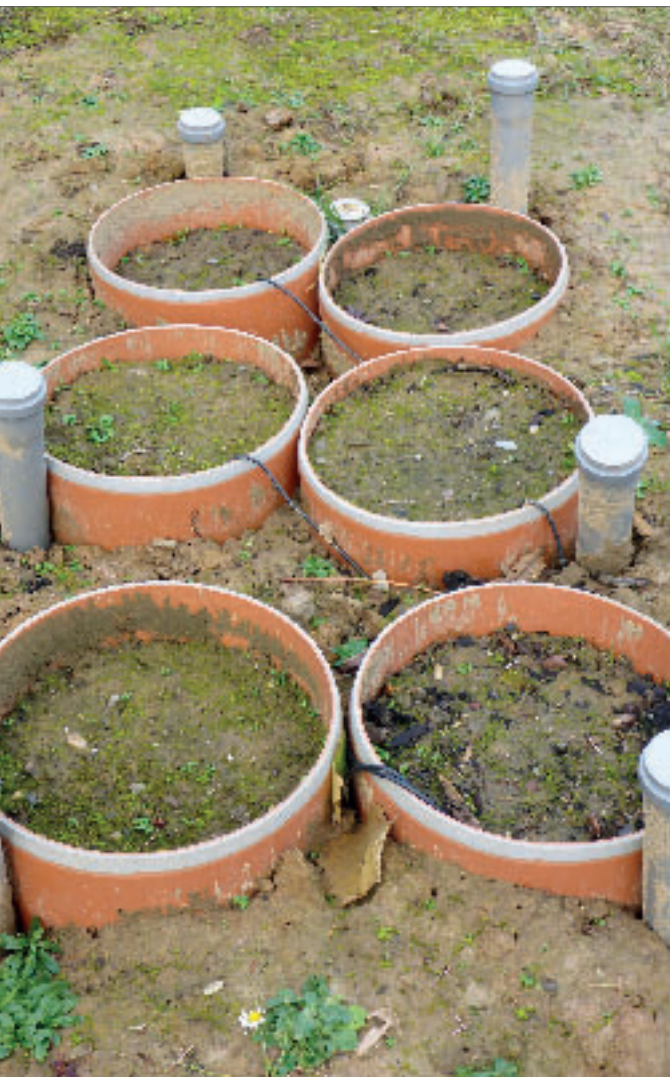
Feldversuch: Säulen mit unterschiedlichen Bodenarten.
